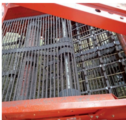
Сепарирующие элеваторы комбайна BR-150.
