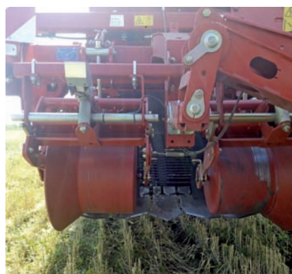
Секция подкапывания клубней картофеля комбайна BR-150.
